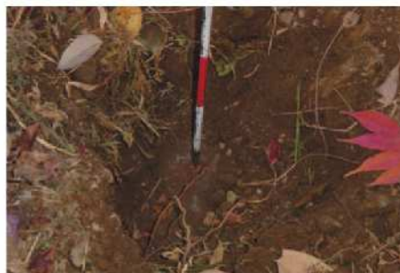
時間の経過により埋もれてしまった境界標(都市部での例)
