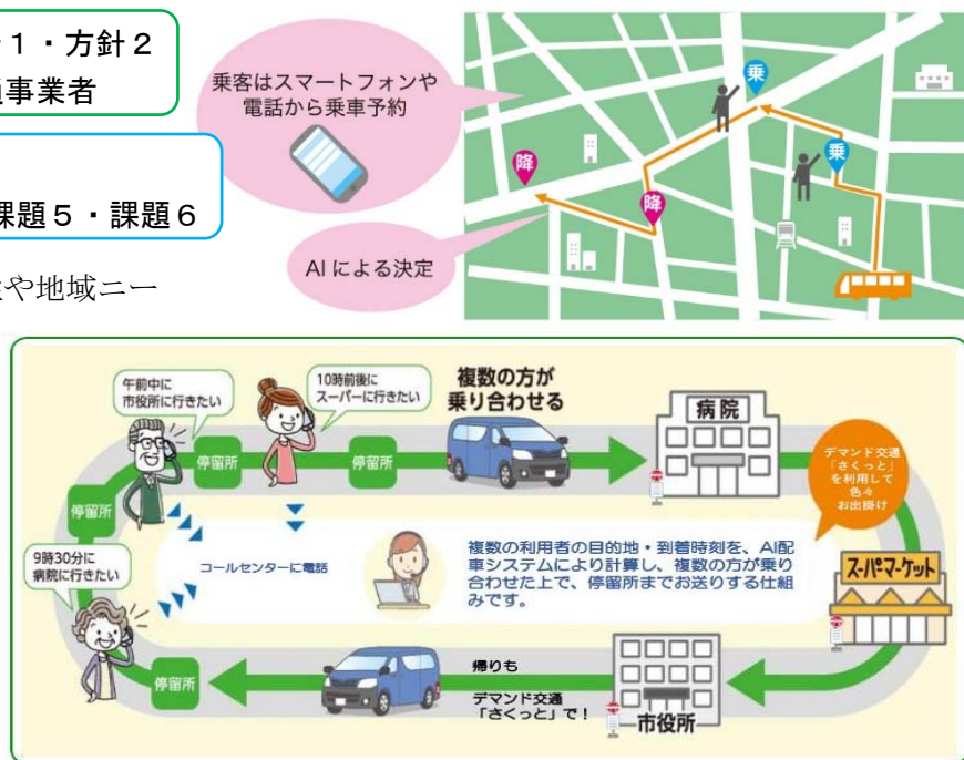
図. AI オンデマンド交通の運行の仕組み
