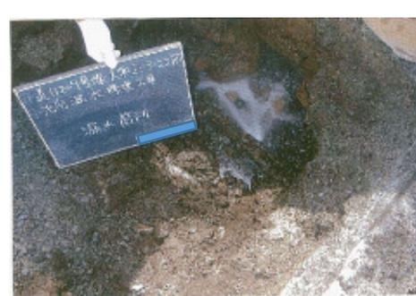
配水支管の老朽化による漏水事故
