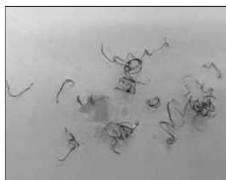
振動切削による切粉
