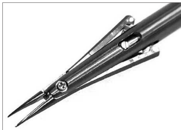
〈試作例〉手術ロボット用鉗子 (nanoTi使用)
