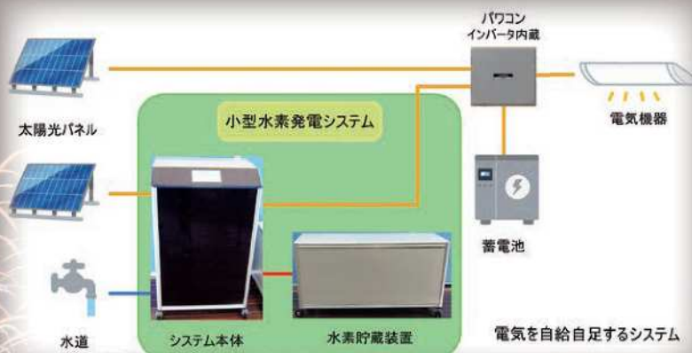
小型水素発電システム Compact-sized hydrogen power generation system
