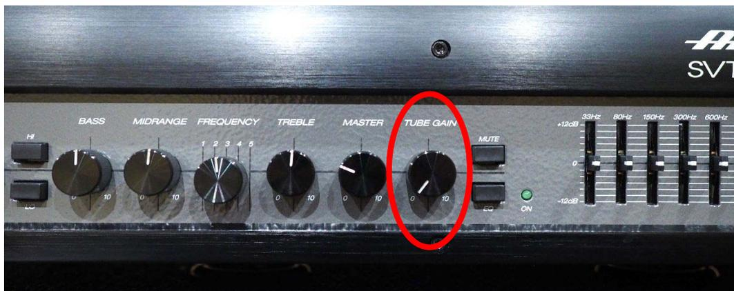
真空管の作動電圧を調整するツマミです。
