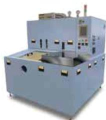
フッ素系洗浄機は低消費電力のため、脱炭素にマッチした工業用洗浄機です。ただし、フッ素系溶剤が高価なため、溶剤消費量を大幅に減らす必要がありました。削減技術開発を行った結果、溶剤蒸発ロスゼロの画期的な洗浄機ができました。
