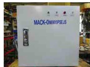
放送局はどんなときでも放送を継続する必要があるため、FMコミュニティの送信所は発電機頼りです。また、送信所は山の中腹などにあり、トラブルに対してのアフターフォローが大変です。そのため、ガソリンの劣化による燃料交換の必要がなく、CO<sub>2</sub>の排出量が少ないガス燃料を採用した発電機の開発に着手しました。さらに、放送中でも発電機のテスト運転ができるリモートコントロール機能も搭載し、環境に優しく、メンテナンスが不要で、テスト運転をリモート化した非常用ガスエンジン発電機を開発しました。また、非常時(停電時)には自動で起動し、電力供給が可能です。商用電気が復旧すると、自動的に発電機は停止するセルスターター式です。
