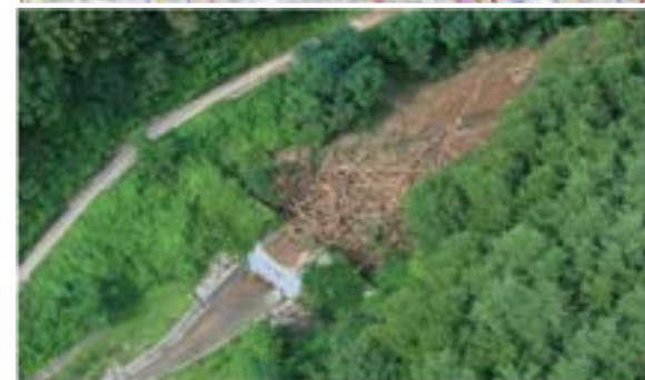
④被災状況 土砂流出量 7,000m 3
