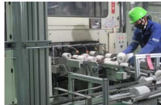
エンボス加工等を施し、長さと幅を規格サイズにカットします。
