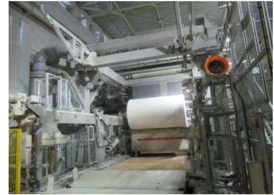
直径約2.5m、幅約3mのジャンボロールをつくります。
