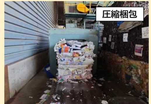
手選別で異物(金属類など)を取り除いた後、機械(ベーラー)で圧縮梱包されます。
