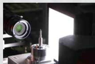
従来、円筒形状の金属部品のキズ検査は自動化が困難でした。そこで、部品を回転させながら新たな画像取得方法で正確に測定して判定することで、キズ検査の自動化を実現しました。
