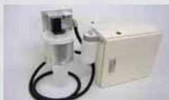
産業用インクジェットプリンタのプリントヘッドは、手作業で洗浄を行っていましたが、オプションとしてプリントヘッド自動洗浄ユニットを開発しました。手作業における有機溶剤使用の安全性、洗浄品質のむら、洗浄にかかる手間といった問題を解消しました。
